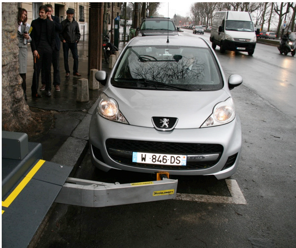
Connexion automatique “mains libres” à la borne de recharge
